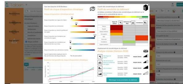
La fiche synthétique Bat-ADAPT montre pour une adresse précise, le profil de risque d'exposition climatique – en l'occurrence pour notre adresse, le risque le plus important est celui d'une remontée des eaux de nappe – et le profil de sensibilité du bâtiment à l'horizon 2030. ©OID
