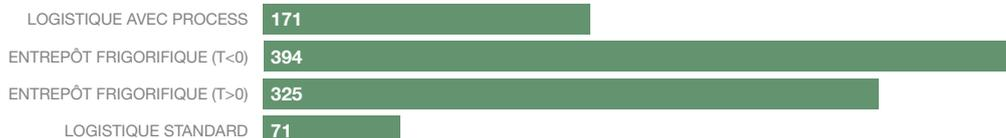
$kWh_{EF}/m^2_{SU}.an$  REFERENCE OID et GRI - Énergie par  $m^2$  de surface utile : GRI CRE1
